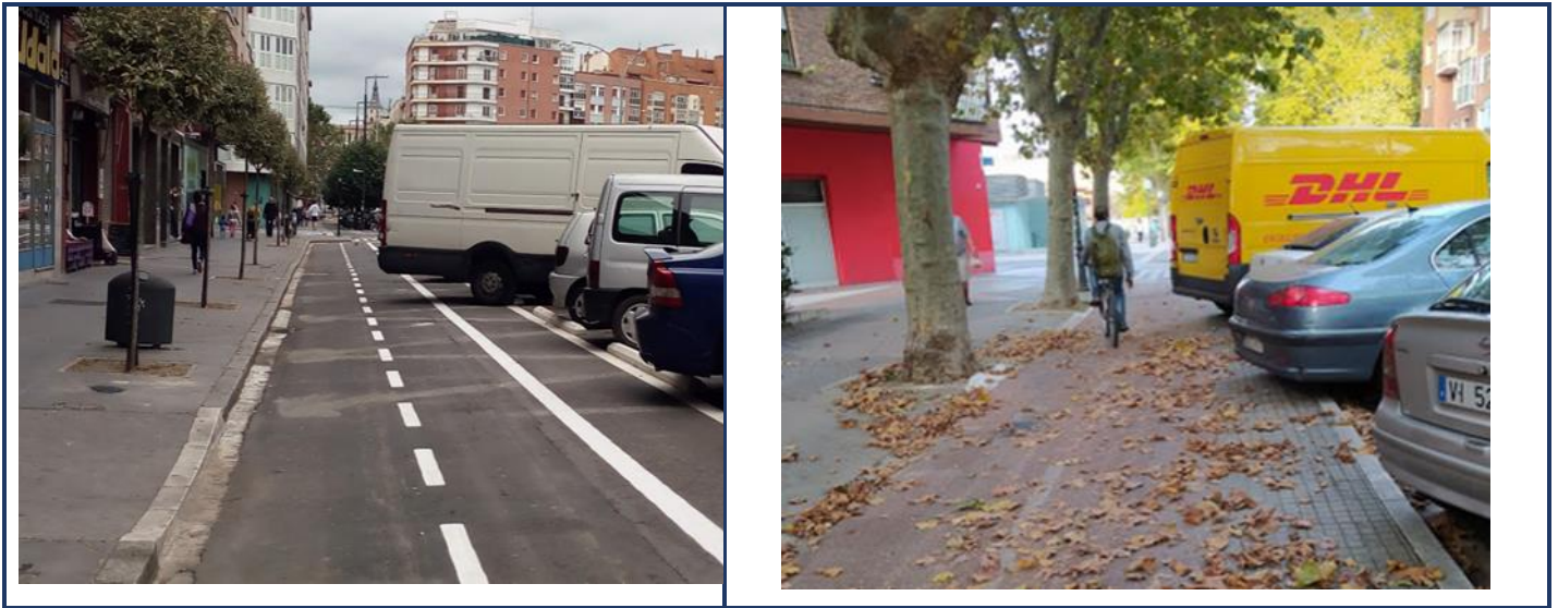
Cuando los carriles bici se sitúan detrás de un aparcamiento marcha atrás, recibe directamente los humos de los tubos de escape y a menudo son invadidos por la parte trasera de vehículos largos
